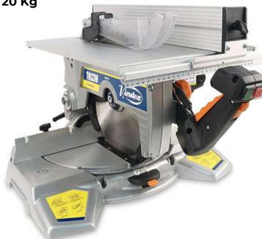
Tronzadora abatible portátil de gran precisión y potencia. Dotada de origen con un disco profesional de 305 mm de diámetro en metal duro y de 48 dientes, ofrece al profesional una capacidad de corte excepcional: hasta 160x95 mm o 200x45 mm con el plato y cabezal a 0°. Equipada con mesa superior con guía y separador de corte.
