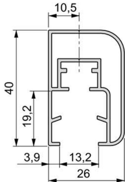
Perfil de remate realizado en aluminio de 40mm de alto, con un diseño limpio y actual para el remate en la zona superior de las cabinas sanitarias, dispone de ranura para el montaje a inglete, permite el atornillado del perfil al panel fenólico, dejando escondido en su interior los tornillos de fijación.
