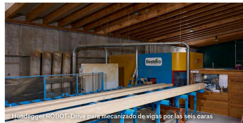
Hundegger ROBOT-Drive para mecanizado de vigas por las seis caras
