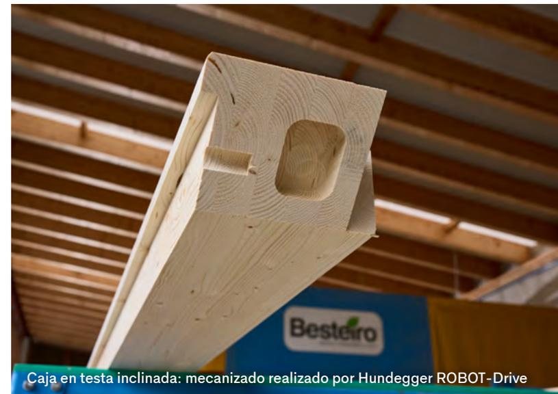
Caja en testa inclinada: mecanizado realizado por Hundegger ROBOT-Drive
