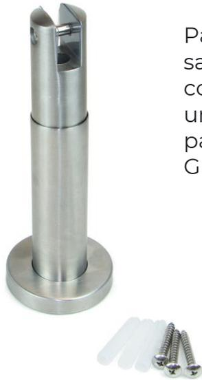
Pata regulable de 100 a 180 mm de altura para cabinas sanitaria para tableros de espesor de 12-13 mm. Fabricado con acero inoxidable AISI-304. El pack contiene 4 unidades con sus complementos de plástico transparente para permitir el ajuste de los paneles. Grado 5 en ensayo de Niebla Salina.
