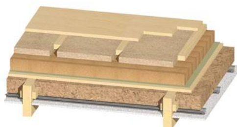
GUTEX Thermosafe-nf ® con rastrel de colocación incorporado y tarima maciza
