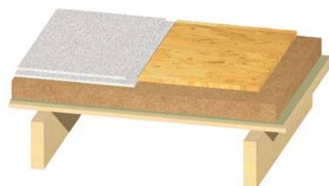
GUTEX Thermosafe-wd ® encima de un entarimado en vigas de forjado
